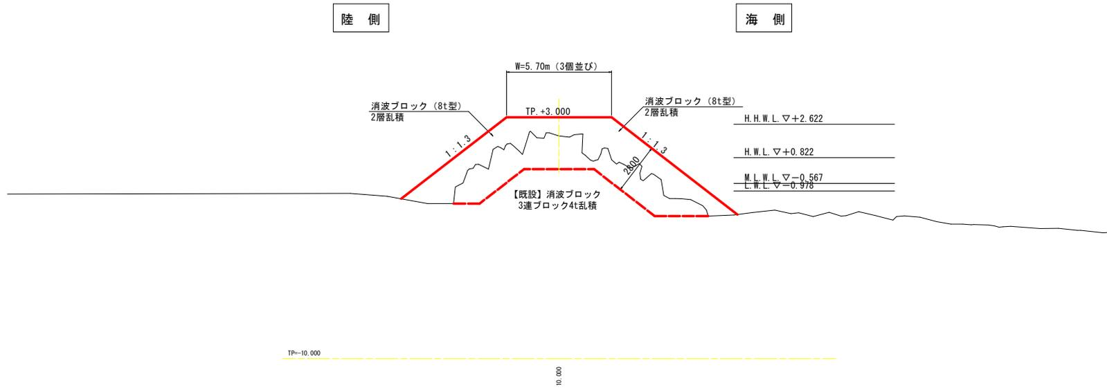
※既設ブロック (4t型) を撤去、再設置及び調整することで、新設ブロック (8t型) が2層乱積できるスペースをすること。
